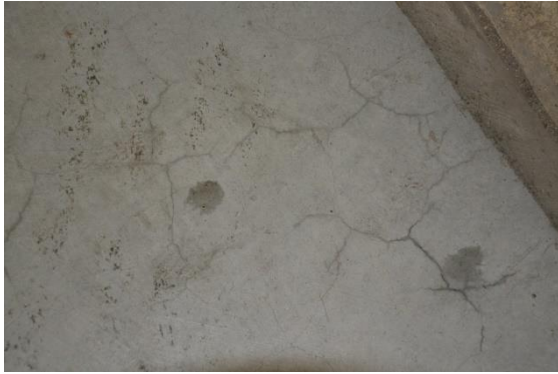
Figur 2.5 Krackelering (t v) på yta 5 (2016) och pinholes (t h) på yta 6 (2015) (Foto: Y Edwards)
