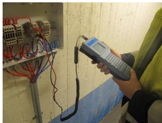
Figur 3.9 Kontrollmätning av skyddsförmågan med extern referenselektrod, Ag/AgCl. (t v) och mätning av de ingjutna anodernas strömavgivning med nollresistans-ampremeter (t h) (Foto: B Sederholm)
