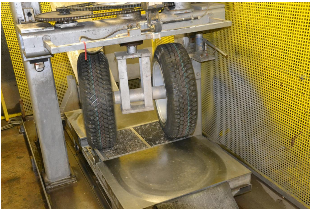
Figur 2.7 Utrustning för provning av Scuffing resistance , med dubbdäck (Foto: Y Edwards)
